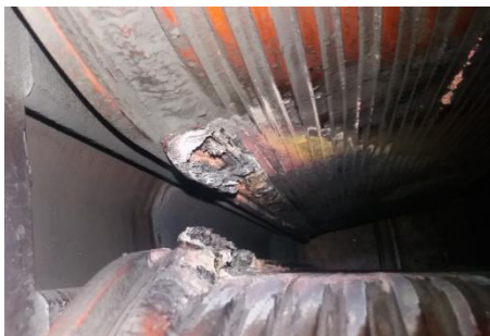
Figura 3 y 4: se evidencia la envergadura del daño a los terminales.
