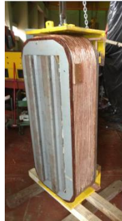
Figura 11: Polo reparado listo para el montaje en la llanta.
