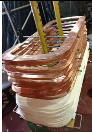
Figura 8: devanado en proceso de replegado y montaje de la aislación.
