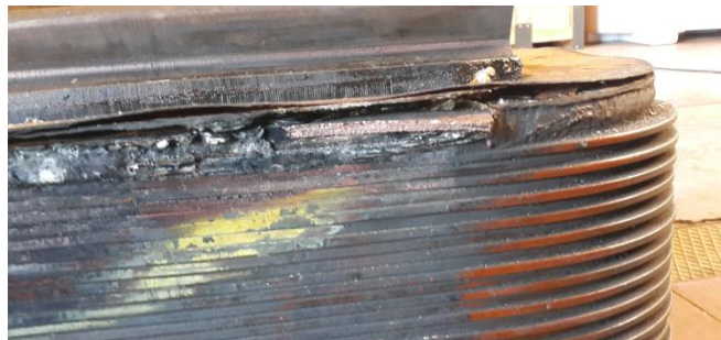
Figura 3 y 4: se evidencia la envergadura del daño a los terminales.
